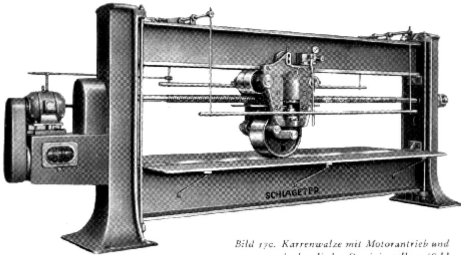
*Bild 17c. Karrenwalze mit Motorantrieb und hydraulischer Druckeinstellung (Schlageter)*
