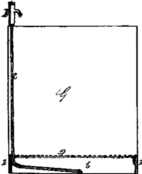
Fig. 20. Versatzgrube mit doppeltem Boden und festlegendem Kupferrohr.
