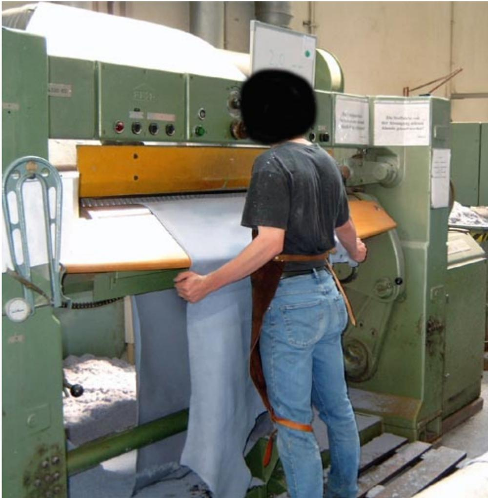
**Hydraulische Falzmaschine 1.6 m Arbeitsbreite mit Haltewalze und Trockenfalzeinrichtung / Absaugung:**
