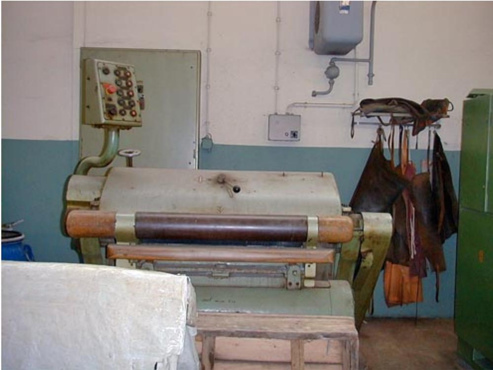
**kleine Ziegentreckenfalzmaschine mit 30 cm Arbeitsbreite voll mechanisch**
