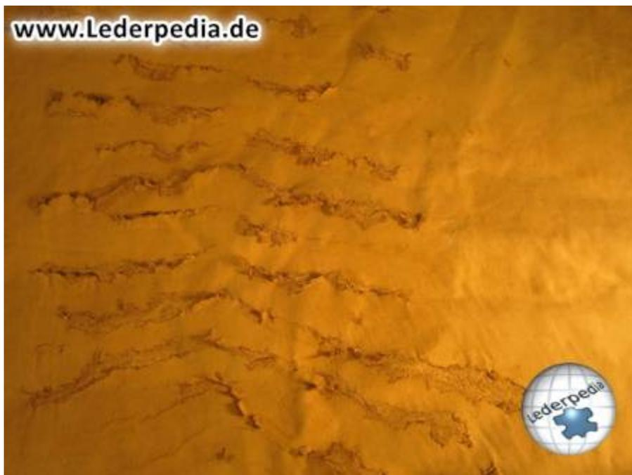
Deutlich sichtbare Doppelhäutigkeit an Schafleder durch Fettrippigkeit mit zusätzlicher maschineller Beschädigung während der Lederherstellung
