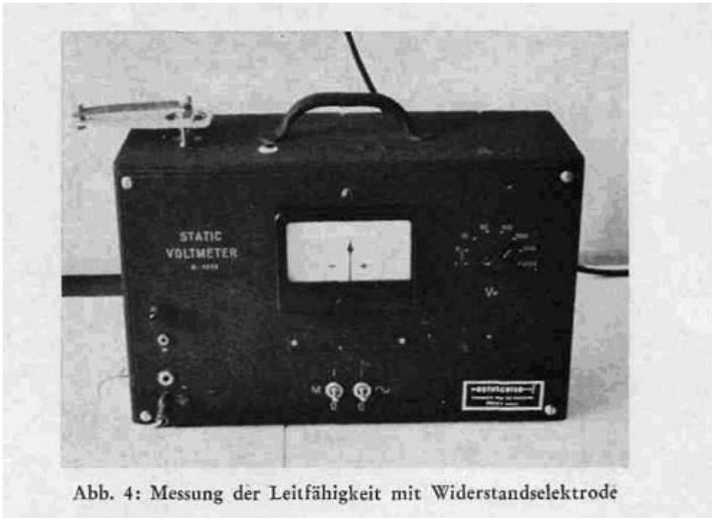
Abb. 4: Messung der Leitfähigkeit mit Widerstandselektrode
