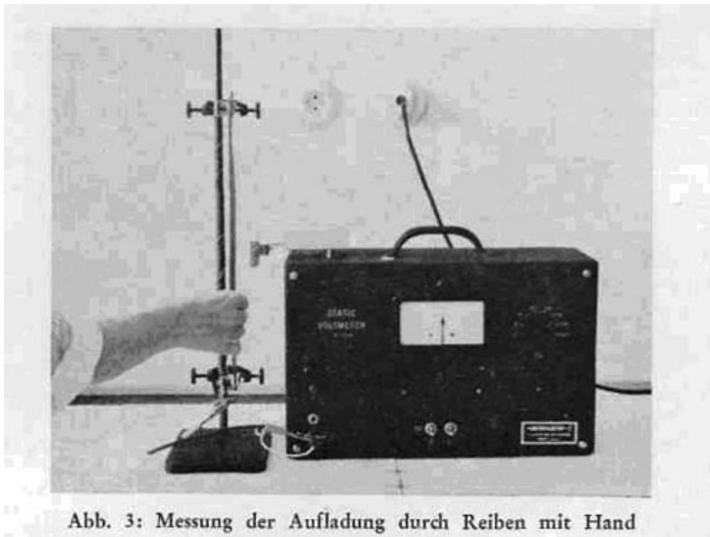
Außerdem wurde mit einer Stoppuhr die Zeit bestimmt, bis die gemessene Anfangsladung der Lederprobe auf die Hälfte abgesunken war. Dadurch erhielten wir zwei Messwerte, die Höhe der Aufladung ( $V_0$ ) und die Feldzerfallshalbwertzeit (FHZ), die ein Maß für die Geschwindigkeit des Abbaues der elektrostatischen Aufladung darstellt. Da die Höhe der Aufladung  $V_0$  für sich allein wenig aussagt, haben wir den Feldzerfallshalbwertzeiten stets größere Bedeutung zuerkannt.
