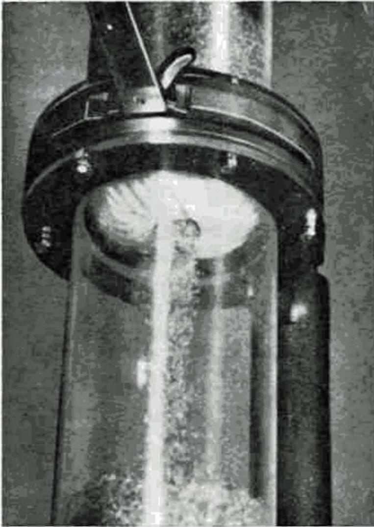
*Abb. 7. Mucon-Ventil zum Dosieren von Festsubstanzen,
