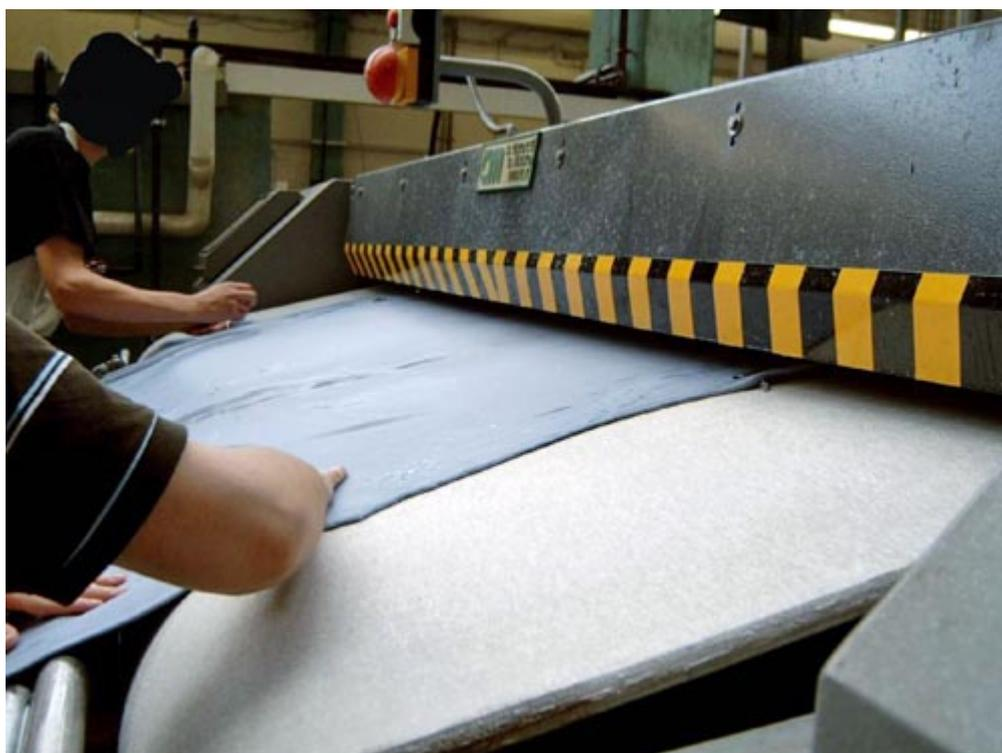
**Lederabnahme nach dem Abwelken auf der Durchlaufabwelkmaschine**
