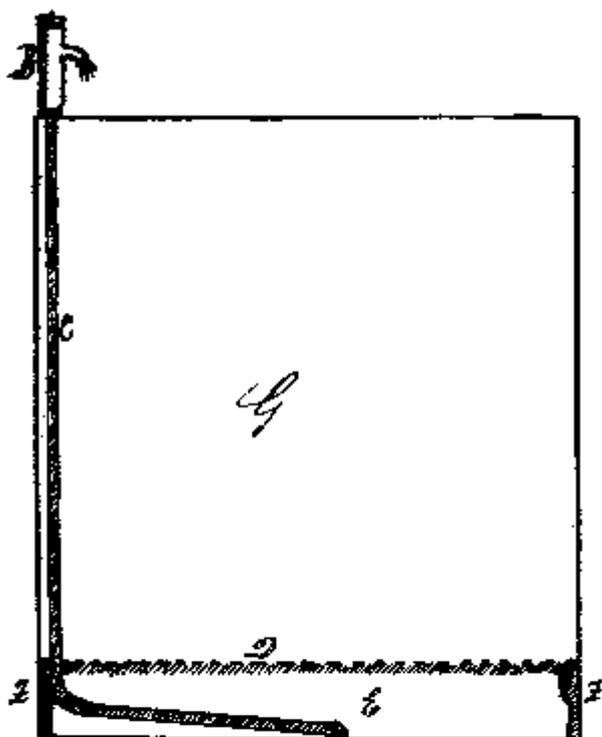
Fig. 20. Versatzgrube mit doppeltem Boden und festliegendem Kupferrohr.
